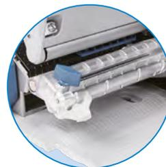
Se utiliza acero inoxidable para la ruta de transporte del papel. La posición de impresión no cambia debido a las ranuras de resina.
